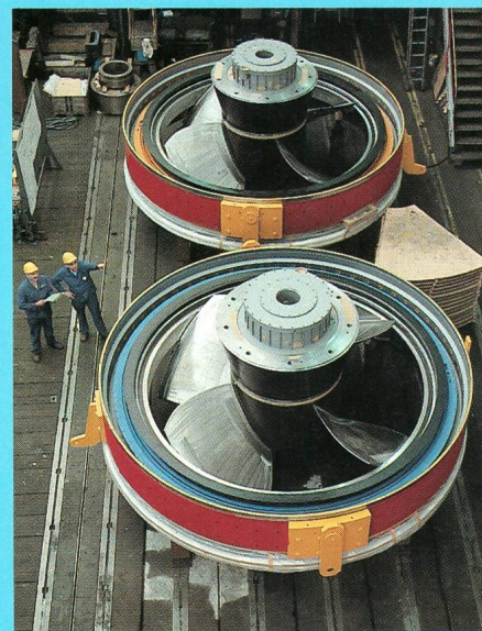
Die Straflo-Lafräder Nr.1 für Augst und Wyhlen sind transportbereit. Vor Ort werden die von ABB gefertigten Generatorpole auf dem Laufradkranz befestigt (Juni 1992).
