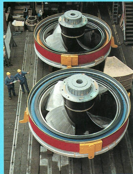
Die Straflo-Lauffräder Nr.1 für Augst und Wyhlen sind transportbereit. Vor Ort werden die von ABB gefertigten Generatorpole auf dem Lauffradkranz befestigt (Juni 1992).
