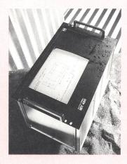
häuse mit 6 HE und einer Tiefe von 350 mm nimmt einen monochromen oder farbigen 14-Zoll-Bildschirm auf. Schnittstellen: RS 232 mit maximal 38,4 KBit, als Option RS 422, sowie Drukkerschnittstelle DEC 423. Speichern lassen sich bis zu sechs Bildschirmseiten, 12 KByte stehen als Makrospeicher zur Verfügung, die menügeführten Einstellungen sind speicherbar.
