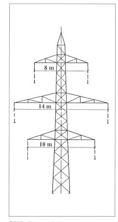
**Bild 8 Tragmast SAE**Mast der 220-kV-Leitung
