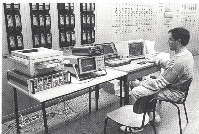
Bild 6 Kommandoraum, niederspannungs- seitiger Teil der Messkette
