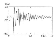
Bild 12 Stromverlauf bei typischem Einschaltvorgang
