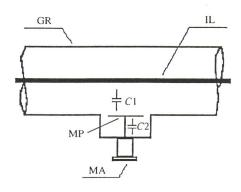
**Bild 1 Pick-up-Elektrode** *GR* GIS-Rohr
