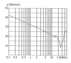
Bild 9 Impedanzgang des Spannungswandlers
