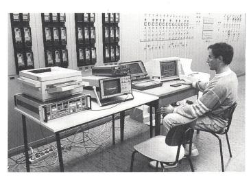
Bild 6 Kommandoraum, niederspannungsseitiger Teil der Messkette
