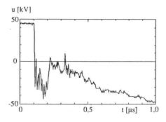
Bild 11 Spannungsverlauf bei typischem Einschaltvorgang
