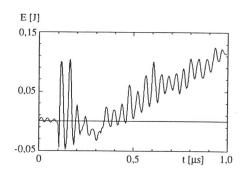
Bild 13 Energieaufnahme bei typischem Einschaltvorgang
