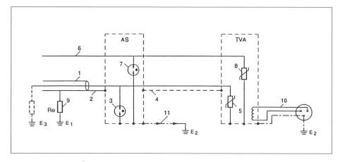
Bild 1 Erdung und Überspannungsschutz bei einer Teilnehmervermittlungsanlage (TVA)
