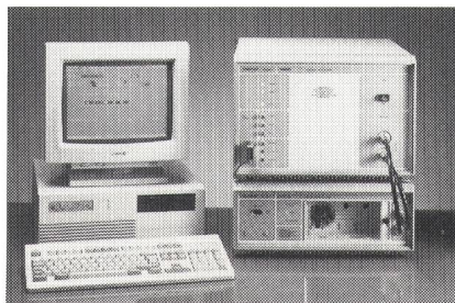
EMV-Prüfungen werden zu Routine-Tests. Die komfortable Bedienung über den PC sichert Reproduzierbarkeit und saubere Dokumentation. Im Bild: 1,2/50-μs-Stossgenerator.
