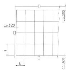
Bild 2 Kenngrössen des Einbausystems Maximale Abmessungen des Einbausystems: Höhe 6 m, Breite: unbegrenzt Rastermass: I = Länge des Laminats + 45 mm; b = Breite des Laminats + 45 mm Minimaler Abstand von Laminatrand zum Rand der Sonnenzellen: 15 mm Zulässige Dicke der Laminate (am Rand):
