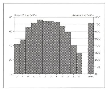
Bild 2 Jahresverlauf der erwarteten jährlichen Elektrizitätsproduktion
