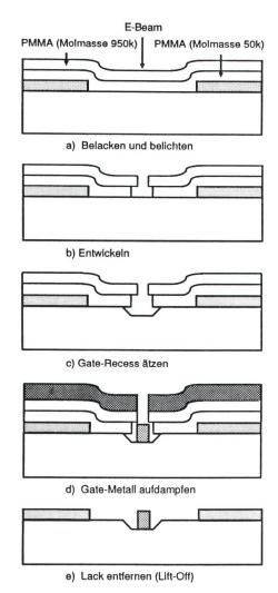
Bild 4 Prozessfolge der Herstellung des Gates
