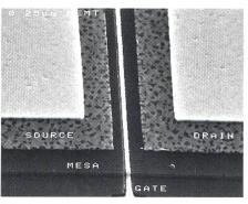
Bild 5 REM-Bild eines HEMT mit Gatelänge von  $0.2 \mu m$
