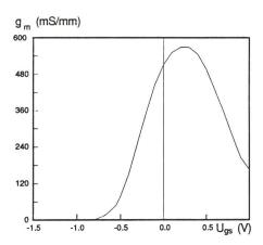
Bild 7  $g_{\rm m}$ - $U_{\rm gs}$ -Kennlinien eines GaAs-Mesfet mit Epitaxie-Kanalschichten
