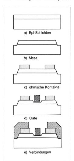
Bild 2 Prozessfolge der FET-Bauelemente-Herstellung
