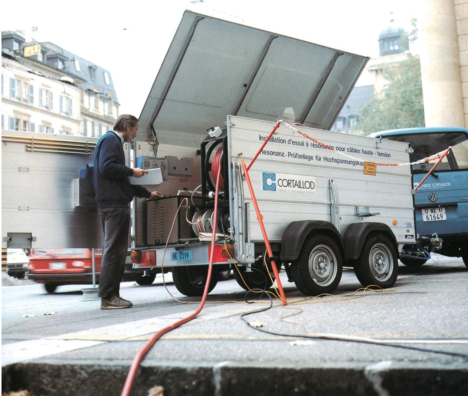
Resonanzprüfanlage für die Vor-Ort-Diagnose der MS-Kabel bis zu 36 kV.
