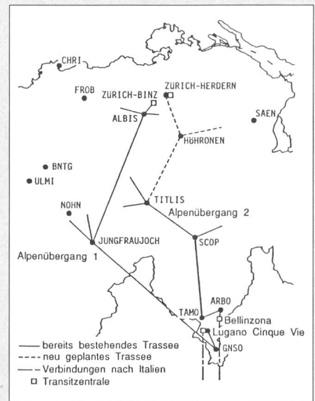
Das PTT-Richtfunknetz zur Erschliessung der Region Zürich
