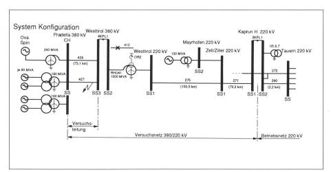
Bild 4 380-kV-Kurzschlussversuche Westtirol-Pradella – Übersichtsschaltbild des 380/220-kV-Versuchsnetzes
