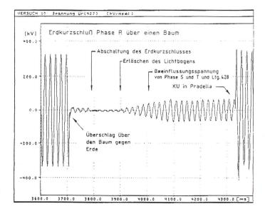
$\begin{array}{c} Bild\ 19 \\ Phasenspannung\ U_R \\ im\ UW-Westtirol\ bei \\ Versuch\ 10 \end{array}$
