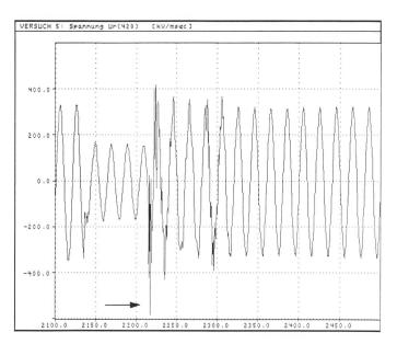
in Westtirol simuliert (Fehlerstrom etwa 1 kA). Schon nach etwa 15 ms erteilte der Distanzschutz LZ96a in Pradella ein dreipoliges Auslösekommando; in Verbindung mit dem schnellen SF<sub>6</sub>-Leistungsschalter wurde somit eine Fehlerdauer von etwa 35 ms erreicht (Bild 14).
