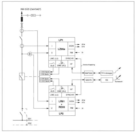
Bild 1 Blockschaltbild des Leitungsschutzes und Zuordnung der Schutzgeräte (Schutzverdoppelung) in Pradella
