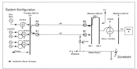
Bild 5 Versuch 1: Zuschaltung auf einphasigen satten Nahkurzschluss in Westtirol, erfolglose einpolige Wiedereinschaltung in Pradella
