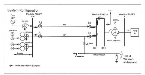
Bild 15 Versuch 8: Einphasiger Widerstandskurzschluss, eingeleitet über einen Wasserwiderstand am Ende der beidseitig gespeisten Leitung. Erfolglose einpolige Wiedereinschaltung gefolgt von einer dreipoligen Definitivabschaltung in Pradella und Westtirol
