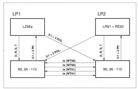
Bild 2 Wiedereinschaltsystem für Schnell- und/oder Langsamwiedereinschaltung Beschreibung des Signalflusses
