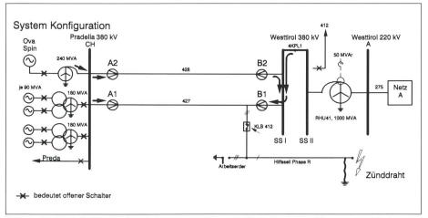
Bild 6 Versuch 2: Einphasiger satter Kurzschluss am Ende der beidseitig gespeisten Leitung, erfolglose einpolige Wiedereinschaltung gefolgt von einer dreipoligen Definitivausschaltung in Pradella
