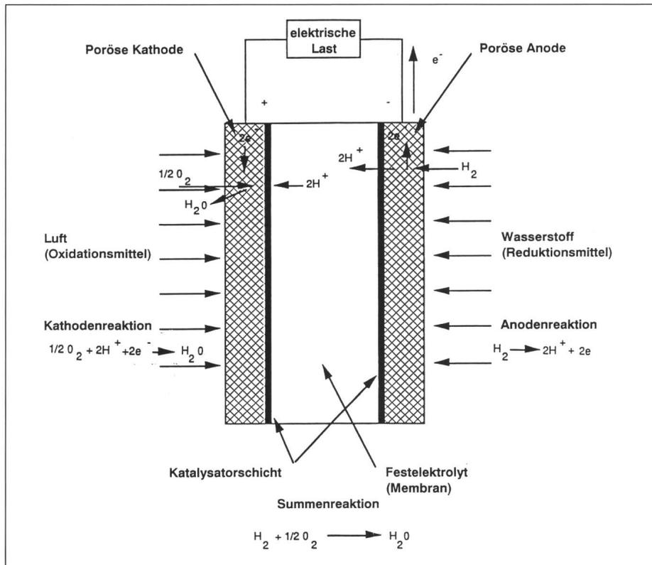
**Bild 5 Elektrochemischer Prozess einer Membran-Brennstoffzelle (Solid Polymer Fuel Cell)**
