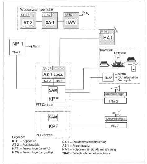
Bild 2 Wasseralarmsteuerung mit Infranet
