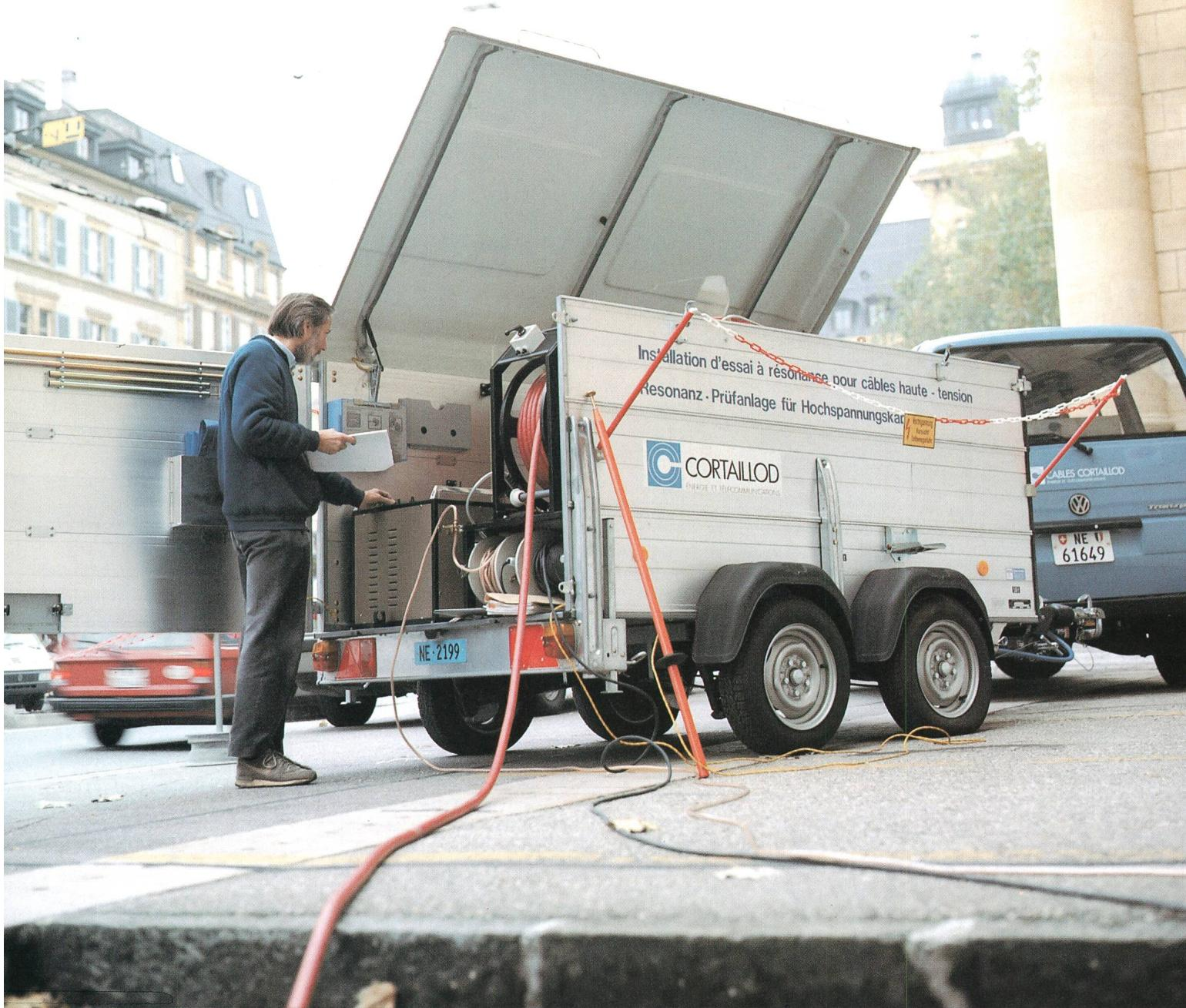
Installation à résonance pour le diagnostic sur site de câbles MT jusqu'à 36 kV.
