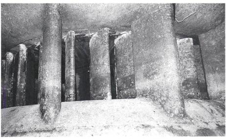
Blick von der Einlaufspirale auf den Leitapparat einer Francisturbine des Kraftwerkes Mühleberg während der Revision
