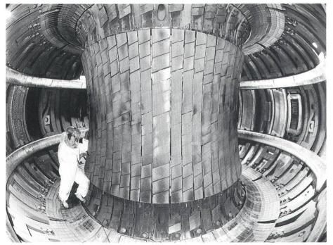
Bild 2 Das Innere des Torus des Jet
