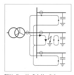
**Bild 6 Kapazitive Erdschluss-Ströme**Einpolige Darstellung der kapazitiven
