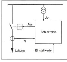
**Bild 1** Hauptelemente eines Schutzsystems
