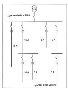
**Bild 2 Beispiel eines Mittelspannungsnetzes** *I<sub>F</sub>* Erdschlussstrom an Fehlerstelle
