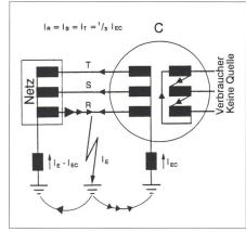
Bild 17 Geerdeter Transformator ohne Einspeisung
