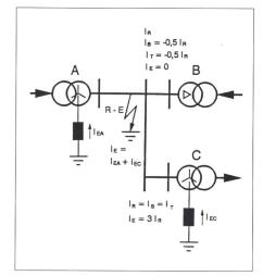
Bild 15 Erdkurzschluss Phase R nach Erde vereinfachtes Netz mit Stationen A, B und C A, B Stationen mit Netzeinspeisung C Stationen ohne Netzeinspeisung
