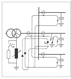
Bild 14 Verstärkung des Wattstromes An der Hilfswicklung der Löschspule wird für kurze Zeit ein Widerstand zugeschaltet
