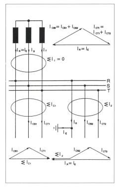
Bild 5 Richtungen der Erdschluss-Ströme im Fehlerfall
