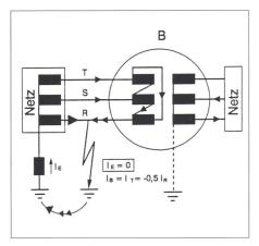
Bild 16 Nicht geerdeter Transformator mit Einspeisung
