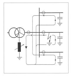
Bild 13 Netz mit Löschspule im Sternpunkt Weg der Erdschluss-Ströme im Netz mit Löschspule im Sternpunkt
