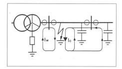
Bild 12 Erdschluss-Ströme bei Widerstandserdung Widerstandserdung ist beispielsweise notwendig bei Tunnelnetzen
