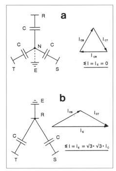
Bild 4 Phasen und Summenströme in einem einfachen Netz
