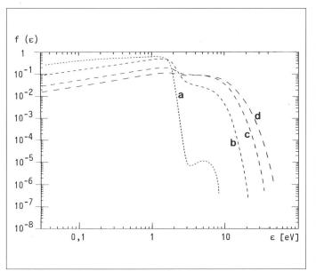
Bild 3 Elektronenenergieverteilung in Abgas Elektronenenergieverteilung  $f(\varepsilon)$  für ein synthetisches Abgas ohne NO, berechnet mit Boltzmann-Code (normiert auf 1) Zusammensetzung des synthetischen Abgases: 13% CO<sub>2</sub>, 80,6% N<sub>2</sub>, 6% O<sub>2</sub>, 0,4% H<sub>2</sub>O a 20 Td 80 Td c 185 Td d 300 Td  $1 \text{ Td} = 10^{-21} \text{ Vm}^2$ ; 4,0467 Td = 1 kV/cm bar
