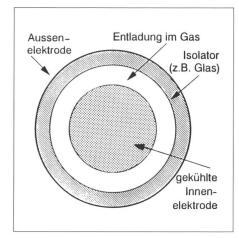
Bild 4 Erzeugung von Barrieren-Entladungen
