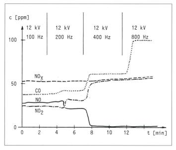
Bild 7 Reaktionen in mit Wechselspannungen betriebener Barrieren-Entladung
