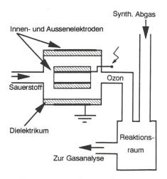
**Bild 5** Abgasbehandlung mit Ozon Schema eines Reaktors zur Abgasbehandlung mit getrennter Ozon-Erzeugung
