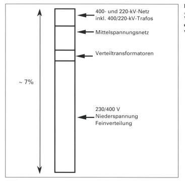
Bild 1 Aufteilung der Verluste in der elektrischen Energieversorgung
