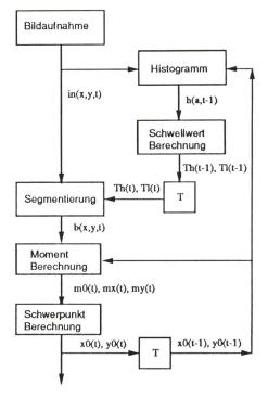
Bild 1 Synchroner Datenflussgraph für ein Trackingsystem
