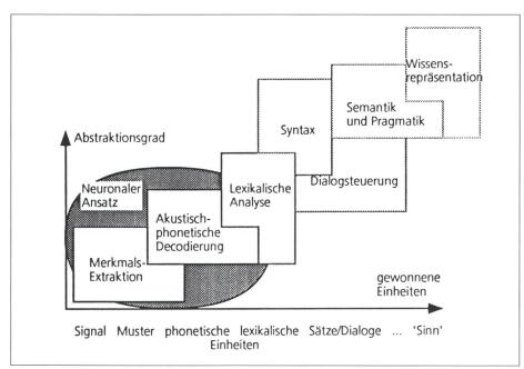
Bild 7 Baukasten der Spracherkennungskomponenten
