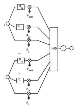
Bild 3 Ein Time-Delay Neural Network-Verarbeitungselement
