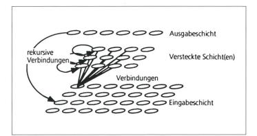
Bild 4 Prinzip der rekursiven Netze
