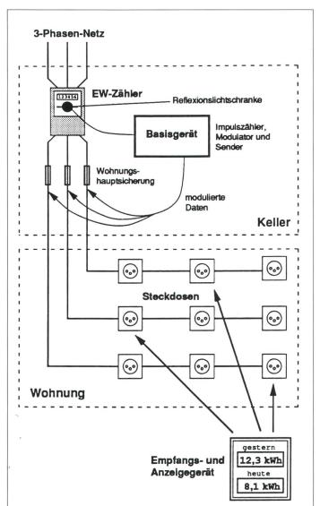
Bild 2 Blockschaltbild eines installierten Stromverbrauchs-Messsystems
