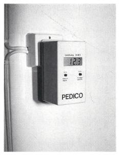
Bild 3 Empfangs- und Anzeigegerät Pedico Das Empfangs- und Anzeigegerät (PEDICO steht für Power and Energy DIsplay for COnsumers). In der Anzeige steht der momentane Gesamtleistungsverbrauch des Haushaltes. Mit den beiden Knöpfen kann kurzzeitig auf den Energieverbrauch des aktuellen oder des vorangegangenen Tages umgeschaltet werden
