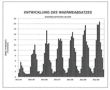
Wärmeabgabe aus dem Kernkraftwerk: Einen anhaltenden Aufwärtstrend verzeichnet die Wärmelieferung an das Fernwärmenetz Refuna im unteren Aaretal (Grafik NOK)
