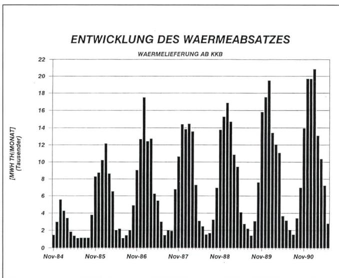
Wärmeabgabe aus dem Kernkraftwerk: Einen anhaltenden Aufwärts-trend verzeichnet die Wärmelieferung an das Fernwärmennetz Refuna im unteren Aaretal (Grafik NOK)
