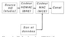
Figure 4 Chaîne de codage HDMAC
