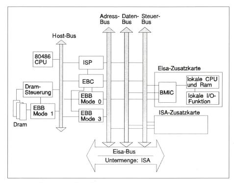
Bild 4 CPU-Platine mit CPU 80486, Eisa-Chipset 82350, Bus und Eisa-Zusatzkarte
