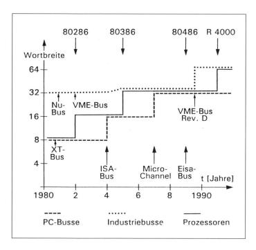
Bild 1 Wortbreiten einiger Prozessoren und Busse
