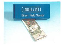
Landis & Gyr hat für die Messung elektrischer Energie einen neuartigen Sensor entwickelt. Dieses «Direct Field Sensor» oder DFS genannte Messelement basiert auf dem Hall-Effekt und misst direkt das zum Strom eines Leiters proportionale Magnetfeld. Bitte informieren Sie sich an der
