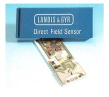
Dank der Möglichkeit des Hall-Effekts, das einwirkende Magnetfeld mit einem zusätzlichen Eingangssignal zu multiplizieren, kann das Produkt aus Strom und Spannung direkt gebildet werden. Damit ist es möglich, auf natürliche Art ein zur Leistung proportionales Ausgangssignal zu erzeugen. Das
