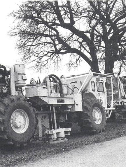
Für die seismischen Untersuchungen setzt die Nagra fahrbare Vibratoren ein, die schwache seismische Wellen erzeugen
