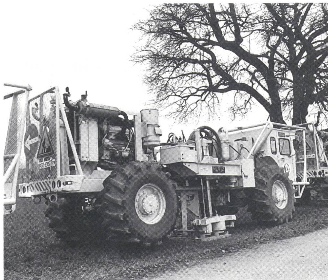
Für die seismischen Untersuchungen setzt die Nagra fahrbare Vibratoren ein, die schwache seismische Wellen erzeugen Dans le cadre de ses études sismiques, la Cédra utilise des vibreurs mobiles qui produisent de faibles secousses sismiques
