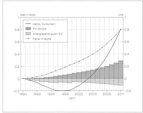
Bild 3 Gesamtenergiebilanz des angenommenen Entwicklungsszenarios
