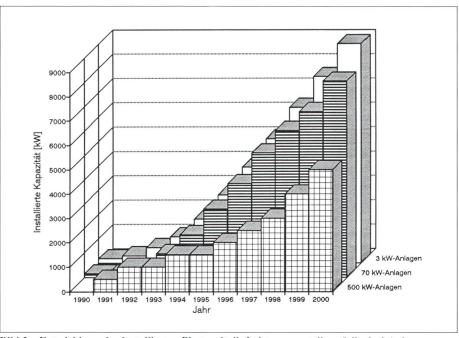
Bild 2 Entwicklung der installierten Photovoltaik-Leistung, verteilt auf die drei Anlagekategorien
