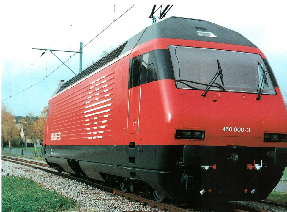
«Locomotive 2000» (Re 4/4 VI) des Chemins de Fer Fédéraux avec une puissance maximale de 6100 kW et une vitesse maximale de 230 km/h. ►
