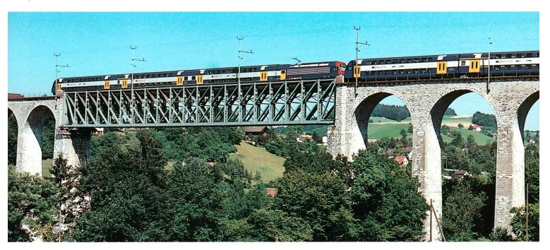
«Locomotive 2000» (Re 4/4 VI) des Chemins de Fer Fédéraux avec une puissance maximale de 6100 kW et une vitesse maximale de 230 km/h.
