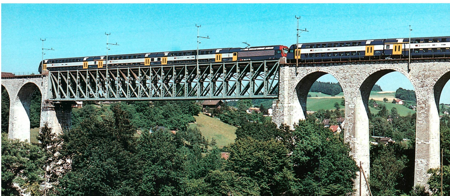
«Locomotive 2000» (Re 4/4 VI) des Chemins de Fer Fédéraux avec une puissance maximale de 6100 kW et une vitesse maximale de 230 km/h. ►
