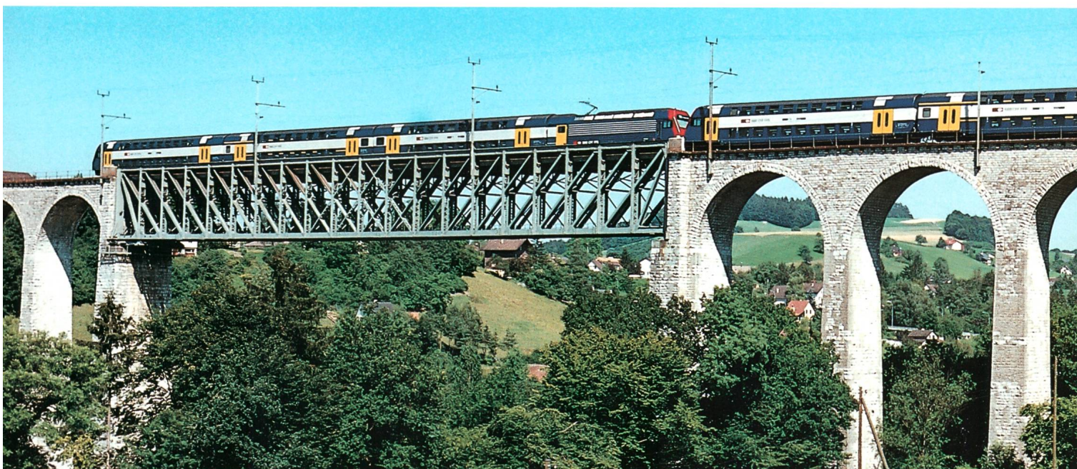
«Lokomotive 2000» (Re 4/4 VI) der Schweizerischen Bundesbahnen mit 6100 kW Höchstleistung und 230 km/h Höchstgeschwindigkeit. ►
