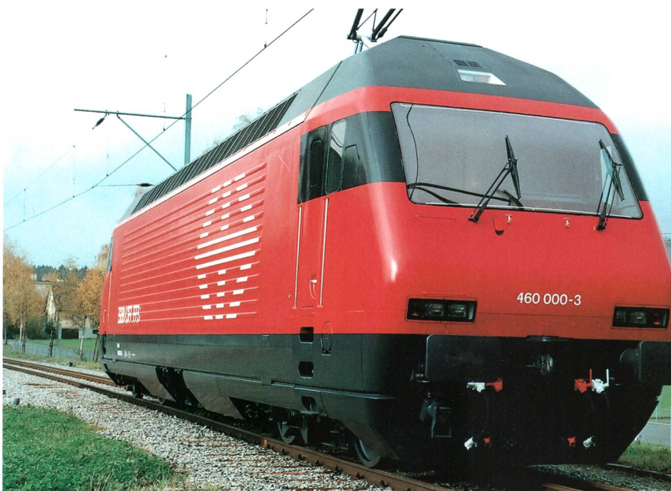
«Lokomotive 2000» (Re 4/4 VI) der Schweizerischen Bundesbahnen mit 6100 kW Höchstleistung und 230 km/h Höchstgeschwindigkeit. ►
