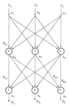
Bild 1 Aufbau eines Mehrschicht-Perzeptrons
