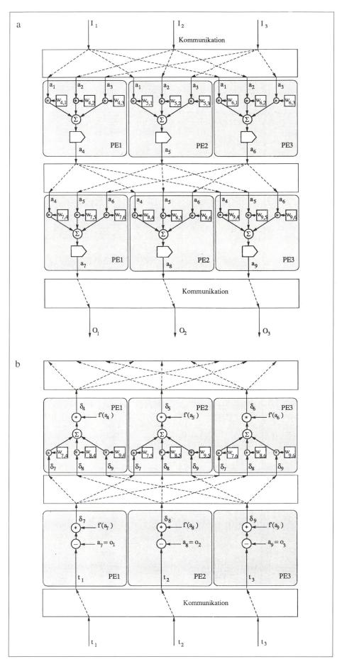
Bild 6a, 6b Partitionierung des neuronalen Netzes
