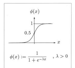
Bild 6 Sigmoidale Aktivierungsfunktion  $\Phi(x)$  des neuronalen Netzwerkes  $f(\cdot) = \Phi(\cdot)$  für alle Neuronen
