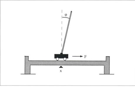
Bild 3 Balancieren eines auf einem Wagen montierten Stabes
