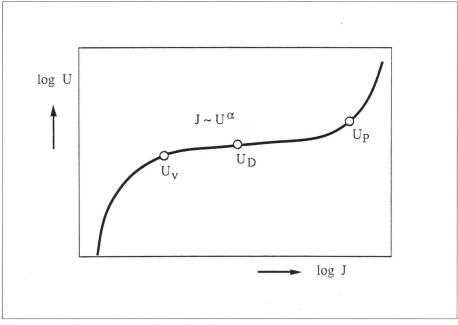
Bild 4 Strom-Spannungs-Kennlinie eines ZnO-Varistors (schematisch)
