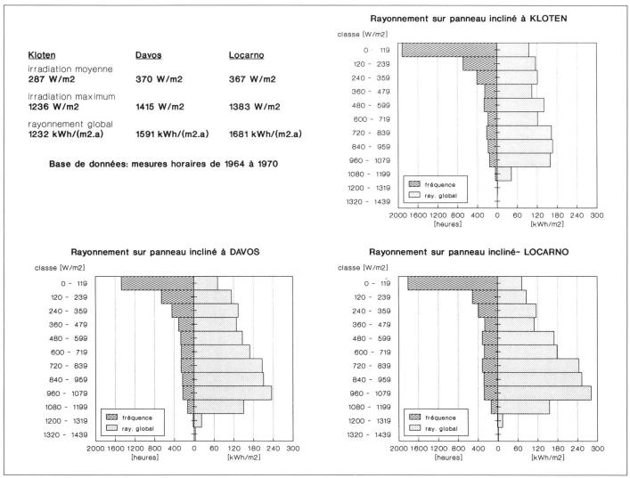
Figur 3 Histogrammes d'irradiation solaire sur une surface inclinée à 45 degrès (moyenne annuelle)
