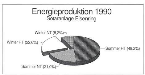
Bild 1 Aufteilung der Energieproduktion 1990 der Solaranlage
