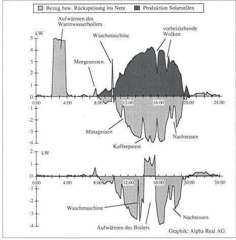
Figur 5 Simulierte Lastverschiebung an einem sonnigen Tag (24. April 1989).
