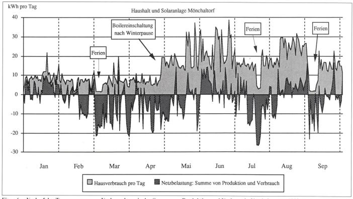
Figur 6 Verlauf der Tagessummen von Verbrauch sowie der Summe von Produktion und Verbrauch (Netzbelastung) 1990. Ist der Wert der Netzbelastung negativ, wurde mehr Strom produziert als verbraucht. Deutlich erkennbar sind der Einschaltpunkt des Boilers und die Ferien. Das Warmwasser wird in diesem Haushalt im Winter mit Holz erwärmt. In der Ferienzeit treten die grössten Produktionsüberschüsse auf.
