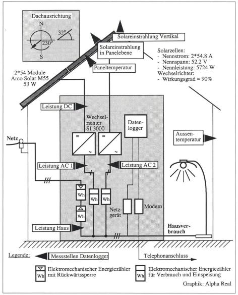
**Figur 1** Anlageskizze der Solarzellenanlage Mönchaltorf. Die Skizze zeigt die wichtigsten Anlageteile sowie alle eingebauten Messsonden. Die umfangreichen Ausmessungen erlauben eine detaillierte Beurteilung der Anlage sowohl in kurzzeitigen als auch in langfristigen Abläufen.
