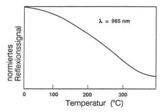
Bild 6 Reflexionssignal eines Silizium-Etalon-Temperatursensors in Funktion der Temperatur
