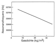
Bild 12 Resonanzfrequenz eines Stimmgabelquarzes in Funktion der Gasdichte bei 25°C
