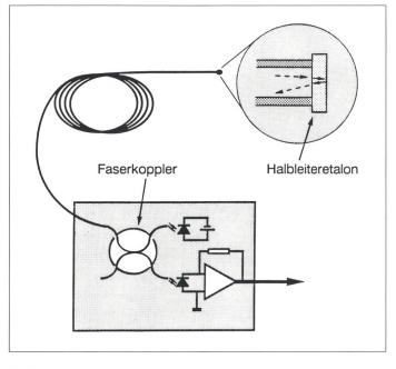
Bild 4 Schematischer Aufbau eines faseroptischen Etalon-Temperatursensors
