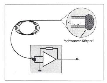
Bild 1 Schematischer Aufbau eines pyrometrischen Temperatursensors
