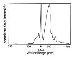
Bild 8 Rückstreuspektrum einer Standard-Multimodefaser, erzeugt von einem HeNe-Laser (Wellenlänge von 632,8 nm)
