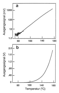
Bild 2 Sensorsignal des pyrometrischen Temperatursensors in Funktion der Temperatur
