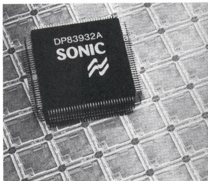
Die neuen Ethernet-Netzwerk-Controller von National Semiconductor Corp. erlauben den Voll duplex-Medienzugriff für 32-Bit/40-MHz-Systeme.
