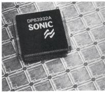
neuen Ethernet-Netzwerk-Controller National Semiconductor Corp. erlauben den Vollduplex-Medienzugriff für 32-Bit/40-MHZ-
