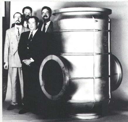
Weltgrösstes SF 6 -Schalter-Gehäuse
