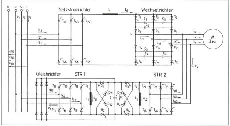
Bild 1 Prinzipschema des aktiven Leistungsfilters
