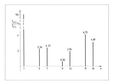
Bild 6 Oberschwingungsspektrum der Eingangs- und Ausgangsströme  $I_{(1)}$  Effektivwert
