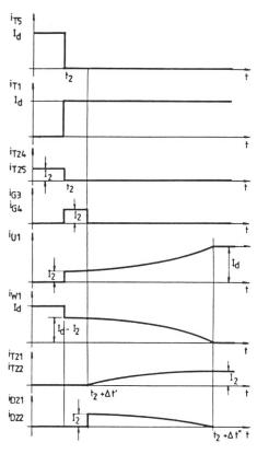
Bild 5 Ausschaltvorgang des Thyristors  $T_5$ : Spannungs- und Stromverläufe
