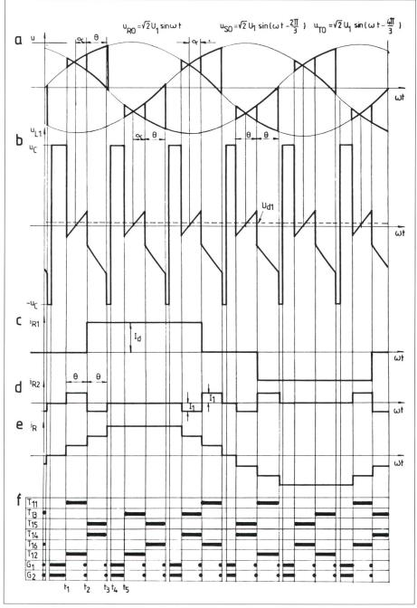
Bild 2 Funktionsprinzip des Stromrichters STR 1
