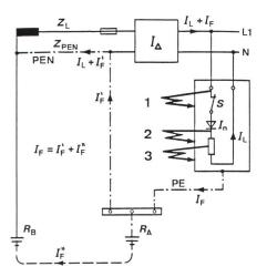
Bild 8 Pulsierende Gleichfehlerströme bei der Nullung
