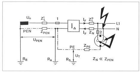
Bild 6 Kein Auslösen des FI-Schutzschalters bei L-N-Kurzschlüssen
