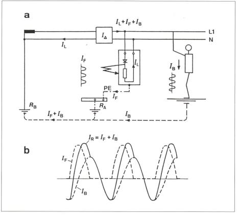
Bild 11 Funktionstüchtigkeit eines FI-Schutzschalters in Geräten mit Gleichrichterschaltungen
