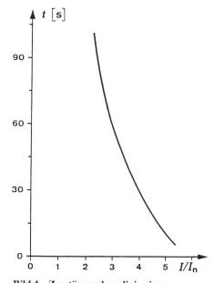
Bild 4 Zerstörungskennlinie eines Brückengleichrichters mit 6 A Nennstrom  $I/I_n$  Belastungsstrom I, bezogen auf den Nennstrom  $I_n$  Belastungsdauer
