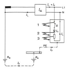
Bild 9 Pulsierende Gleichfehlerströme bei der Fehlerstromschutzschaltung
