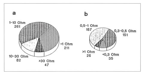
Bild 10 Statistik der Erdungswiderstände und Schleifenwiderstände in Verbraucheranlagen
