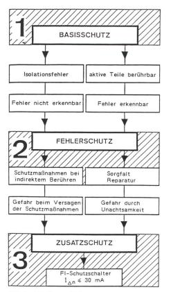
Bild 5 Dreifache Sicherheit durch kaskadenförmigen Aufbau des Schutzes Durch einen kaskadenförmigen Aufbau des Schutzes aus Basisschutz, Fehlerschutz und Zusatzschutz wird eine dreifache Sicherheit gegen gefährliche Körperströme erreicht
