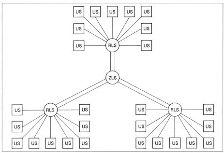
Bild 5 Beispiel für ein sternförmiges Netz
