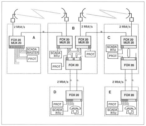
${\bf Bild~8} \quad {\bf Redundantes~digitales~Netz,~aufgebaut~mit~optischen~Teilstrecken~und~digitalem~Richtfunk}$
