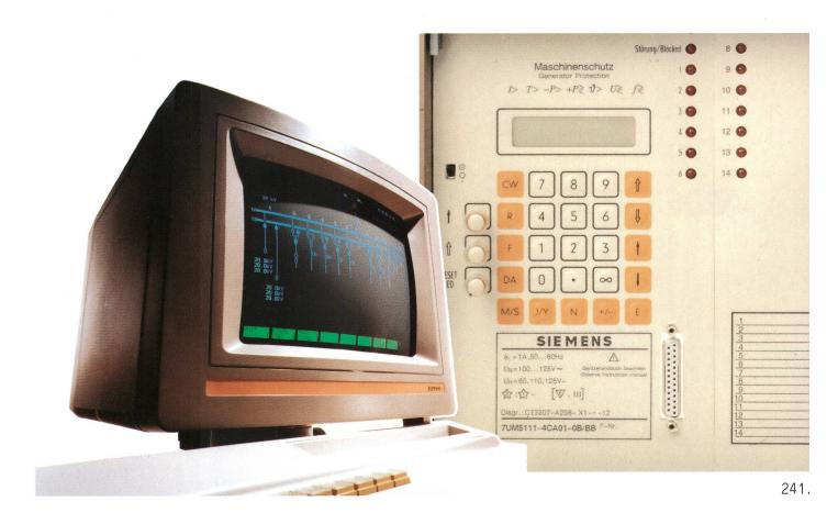
Stationsschutz, Abzweigschutz und Maschinenschutz. Der Stationsschutz mit dezentralen und zentralen Intelligenzen sorgt für Sammelschienen-und Schaltversagerschutz. Der Abzweigschutz verfügt neben der Basisfunktion Distanzschutz über die Zusatzfunktionen Wiedereinschalten, Fehlerortung,
