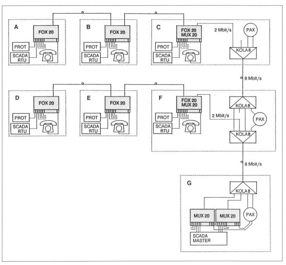
Bild 7 Ausbau der Hauptverbindung zu einem optischen 8-Mbit/s-System
