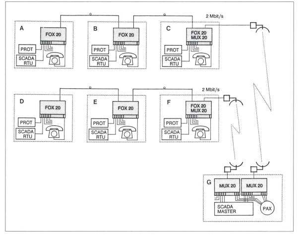
Bild 6 Kopplung eines optischen Teilsystems mittels digitalem Richtfunk
