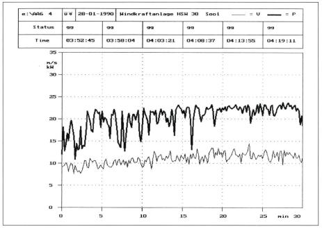
Bild 7 Anlage im Regelbetrieb mittels Blattverstellung
