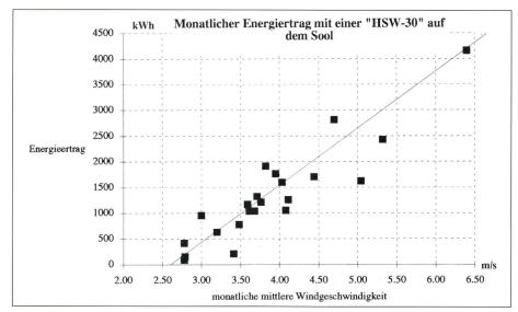
Bild 9 – Streuung der monatlichen Energieerträge bei unterschiedlichen mittleren Windgeschwindigkeiten / Monat
