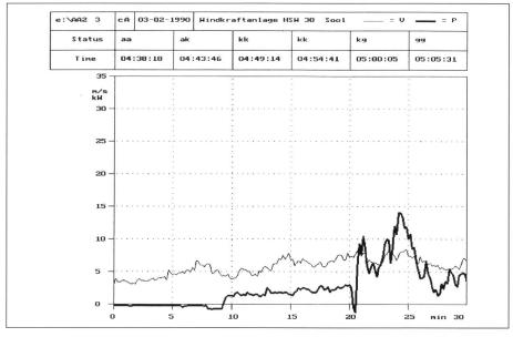
Bild 5 Windgeschwindigkeit und produzierte Leistung bei einem Anfahrvorgang
