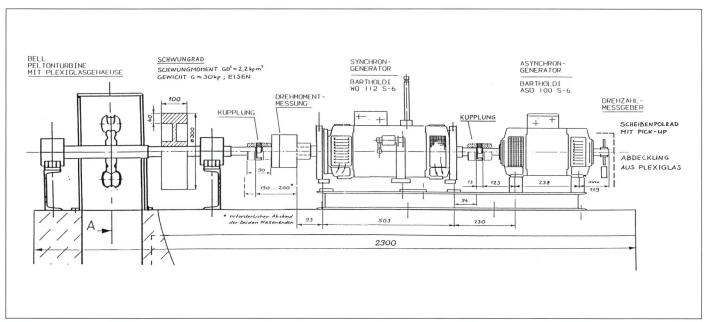
Bild 3 Die Maschinengruppe des Demonstrationskraftwerkes
