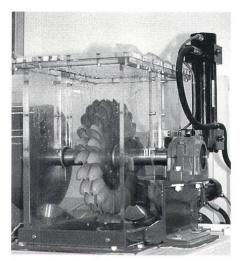
Bild 2 Die durchsichtige Verschalung macht das Turbinenrad in voller Aktion sichtbar
