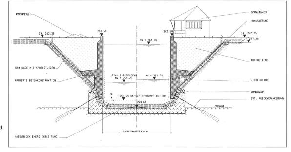
Bild 8 Bei der Sanierung der Schiffahrtsschleusen werden senkrechte Trogwände erstellt und gleichzeitig die Länge auf 110 m Nutzmass erhöht
