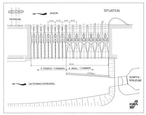
$Bild\ 6\quad Im\ bestehenden\ 10\text{-}Meter-Achsabstand\ werden\ die\ neuen\ Straflo-Maschinen\ anstelle\ der\ alten\ Francis-Turbinen\ installiert$
