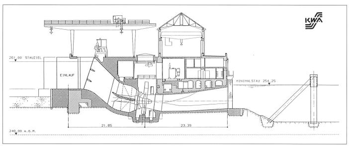
Bild 10 Querschnitt durch die künftige Anlage
