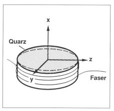
Bild 3 Quarzscheibe mit aufgewickelter Glasfaser
