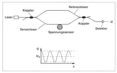
Bild 5 Faser-Mach-Zehnder-Interferometer
