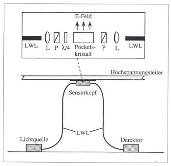
Bild 2 Schematischer Aufbau eines Pockelssensors. (LWL = Lichtwellenleiter, L = Linse, P = Polarisator, λ/4 = Viertelwellenlängenplättchen)
