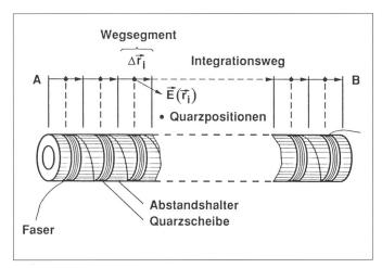
Bild 4 Faseroptischer Spannungssensor
