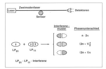
Bild 7 Zweimodenfaser-Interferometer
