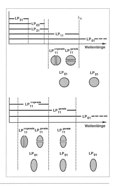
Ausbreitungsfähige Fasermoden in Abhängigkeit von der Wellenlänge für
