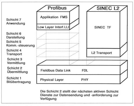
Bild 5 Kommunikation über Profibus und Sinec L2
