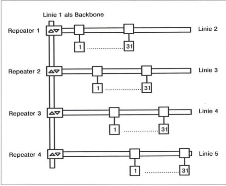
Bild 1 Bustopologie mit 4 Repeatern und 32 Anschlüssen pro Linie
