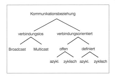
Bild 4 Typen von Kommunikationsbeziehungen
