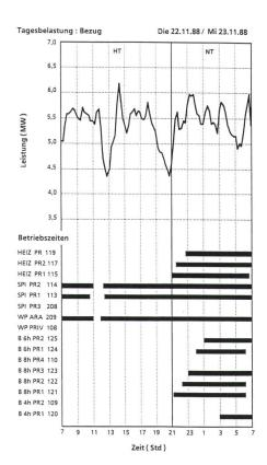
Bild 5 Spitzenlasttag mit festen Schaltzeiten der Rundsteuerung vor Inbetriebnahme der Energieregelung
