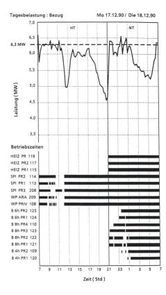
Bild 7 Spitzenlasttag mit Energieregelung Obwohl in den einzelnen Messperioden die maximale Leistung überschritten wurde, konnte durch die Energieregelung sichergestellt werden, dass die vorgegebene maximale Bezugsleistung von 6,3 MW eingehalten werden konnte. Aus den als Balken dargestellten Betriebszeiten geht hervor, welche Verbrauchergruppen durch die Energieregelung beeinflusst wurden
