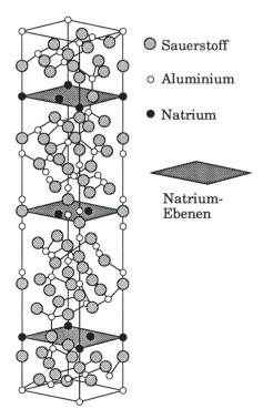
Bild 6: Im Kristallgitter von Beta-Aluminiumoxid, chemische Formel  $5Al_2O_3$   $Na_2O_3$  sind die Natrium-Ionen jeweils in einer Ebene bzw. Schicht zwischen viel dickeren Schichten mit Aluminium- und Sauerstoffatomen angeordnet, so dass sie schon bei geringer Energiezufuhr – z.B. leichter Erwärmung – innerhalb einer «Natrium-Ebene» miteinander die Plätze tauschen und sich so durch den Kristall hindurchbewegen
