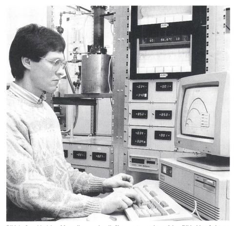
Bild 4 In zahlreichen Messreihen werden die Kennwerte – rechts auf dem Bildschirm Leistung über Stromstärke – von AMTEC-Versuchszellen ermittelt, um Anhaltspunkte für Verbesserungen zu finden Photo ABB
