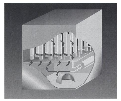
Bild 5 So könnte eine AMTEC-Batterie, eine Zusammenschaltung vieler Zellen innerhalb eines gemeinsamen Kühlbehälters, aussehen. Die Pfeile zeigen den Weg an, den das abgekühlte Natrium nimmt, um von der elektromagnetischen Pumpe in den beheizten Sammelbehälter gedrückt zu werden, aus dem die Zellen gemeinsam mit heissem Natrium versorgt werden.
